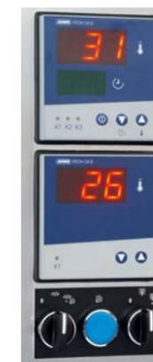
• El termostato superior suministra la potencia a las resistencias superiores, con una duración de 10 segundos.
